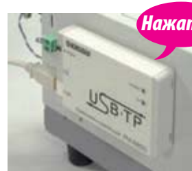
Включает магнитный лист для удержания устройства на месте. Может быть прикреплен непосредственно к источнику питания.
