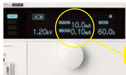
▲ Дисплей настроек испытания высоковольтным напряжением AC (выдерживаемое напряжение) (пример)
