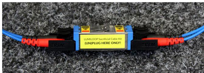
Защищенные оптические кабели поставляются с каждым датчиком напряженности поля. Всегда используйте коннектор типа E2000 показанный выше для оптического разъединения и соединения базового блока и датчика поля. Коннектор типа E2000 включает автоматические заглушки для предотвращения загрязнений и выгорания кабеля. Тем не менее, все оптические коннекторы должны храниться и использоваться в очищенном виде на протяжении всего времени эксплуатации.
