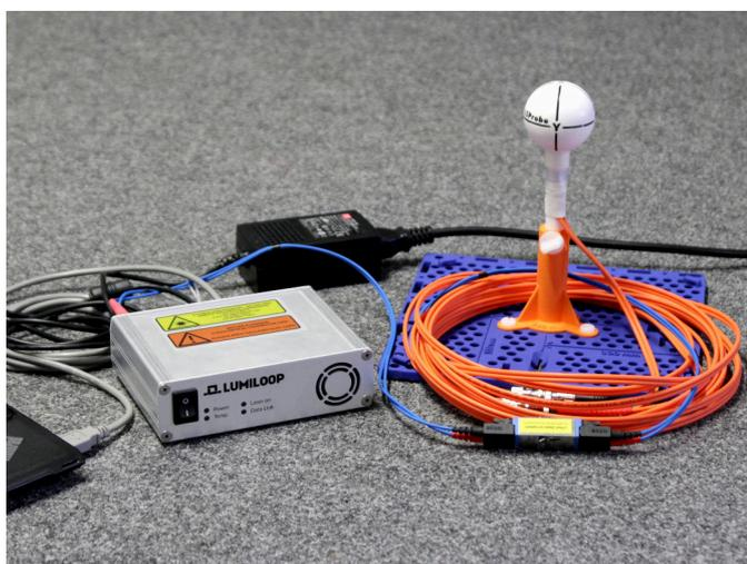
Система LSProbe 1.2 состоит из безбатарейного импульсного датчика напряженности электрического поля и интерфейса для подключения к персональному компьютеру (см. на рис. выше). Интерфейс датчика подключается к персональному компьютеру через USB 2.0.
