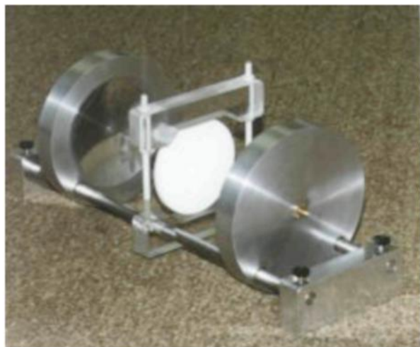
Резонатор модели 600 с контрольным образцом, 15 ... 110 ГГц
