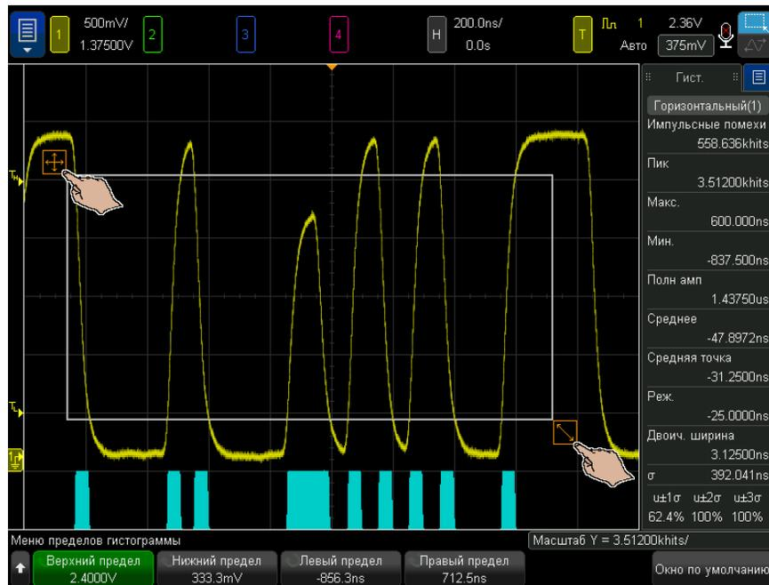
Также размер и местоположение окна с предельными значениями можно изменять с помощью программных кнопок **Верхний предел**, **Нижний предел**, **Левый предел** или **Правый предел** и ручки ввода или диалоговых окон с клавиатурой.
