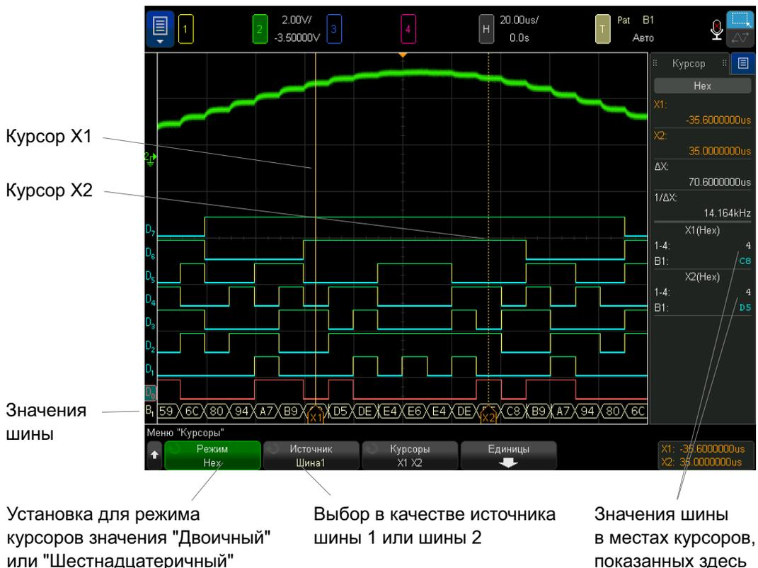
Отображение значений шин при использовании запуска по шаблону
