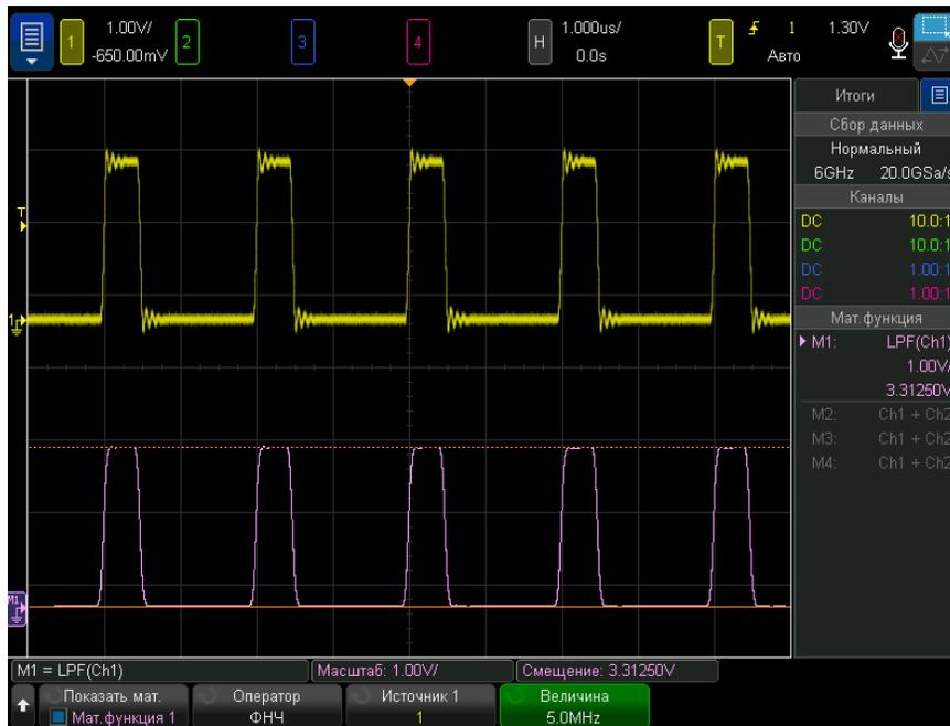
**Рис. 16** Пример фильтра низких частот
