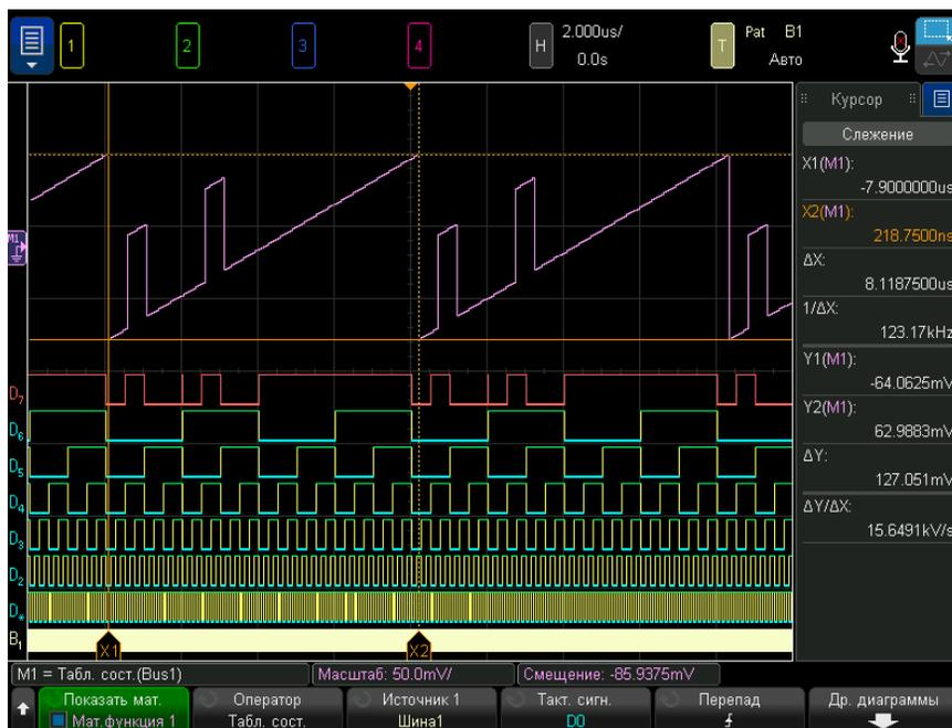
**Рис. 20** Пример графика состояния логической шины
