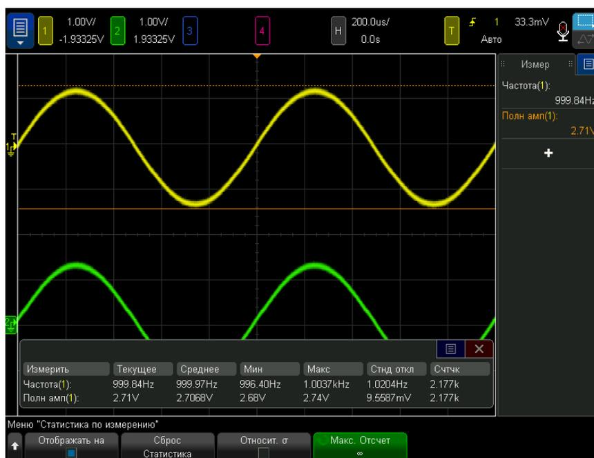
Канал источника измерения указан в кавычках после названия измерения. Например, "**Част(1)**" означает частотное измерение на канале 1.
