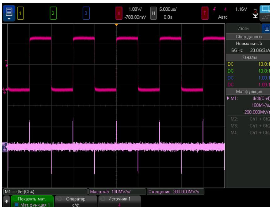
Рис. 7 Пример функции дифференцирования
