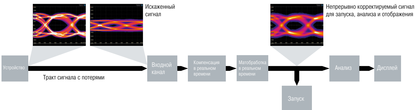
Схема компенсации цепей в реальном масштабе времени
