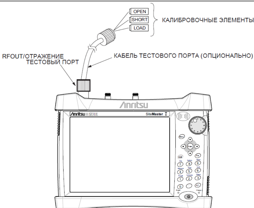
Рис. 3-1. Схема подключения для выполнения калибровки OSL Cal
