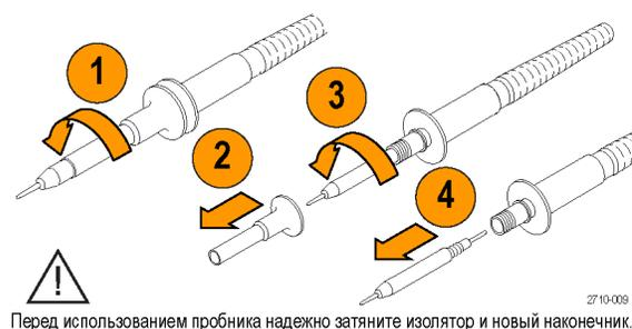
Перед использованием пробника надежно затяните изолятор и новый наконечник.
