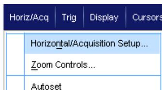
В автоматическом режиме можно настроить масштаб и частоту выборки. Длина записи является независимой переменной. Если в результате изменения масштаба длина записи превысит значение Record Length Limit, то частота выборки уменьшится до следующего доступного значения.
