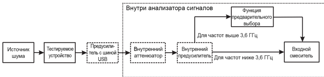
Рис. 3-8. Блоки в тракте передачи сигналов шума при измерениях коэффициента шума.
