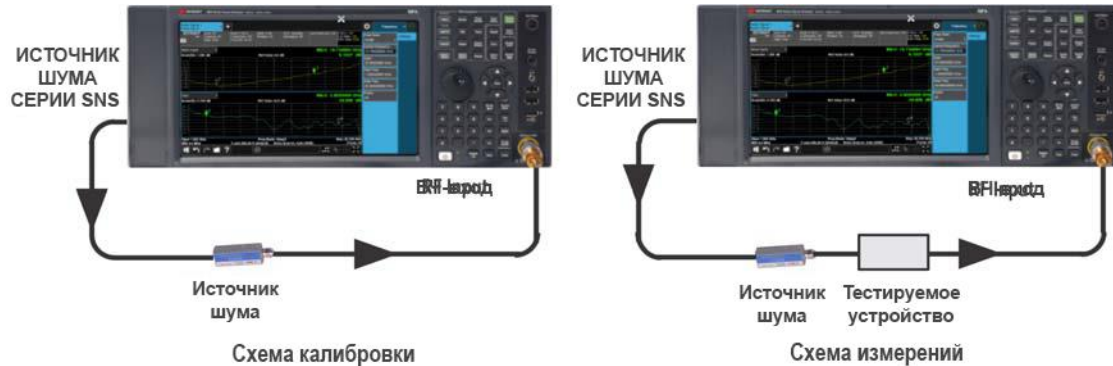
Рис. 2-1. Схемы подключения системы для двухэтапных измерений коэффициента шума
