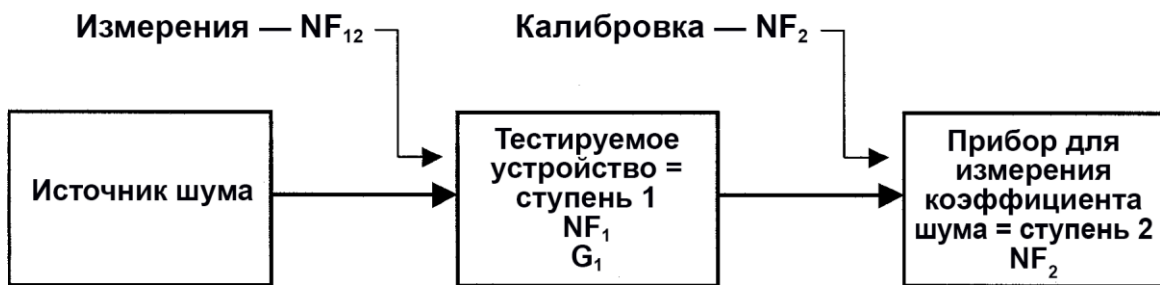
Рис. 1-1. Измерение коэффициента шума с помощью двухступенчатой системы
