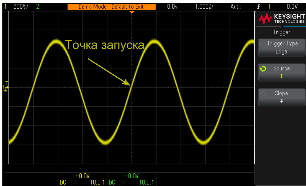
Рис. 12 Синхронизация осциллографа с передним фронтом канала 1 при 0,0 Вольт
