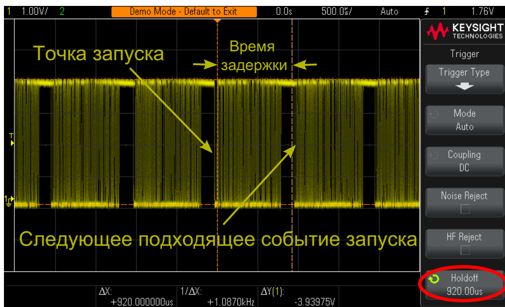
Рис. 27 Использование функции задержки запуска для синхронизации с серией импульсов
