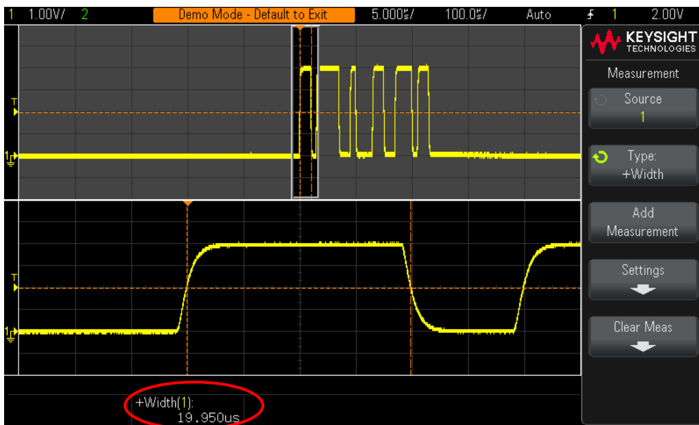
Рис. 38 Использование режима временной развертки с масштабированием для проведения стробированных измерений
