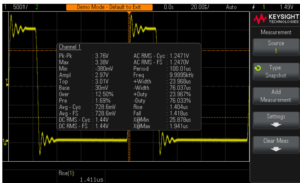
Рис. 35 Проведение сложного набора автоматических параметрических измерений с помощью функции “Общий снимок”
