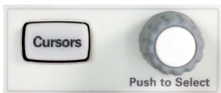
Рис. 10 Ручка [Cursors] Курсоры проведения измерений
