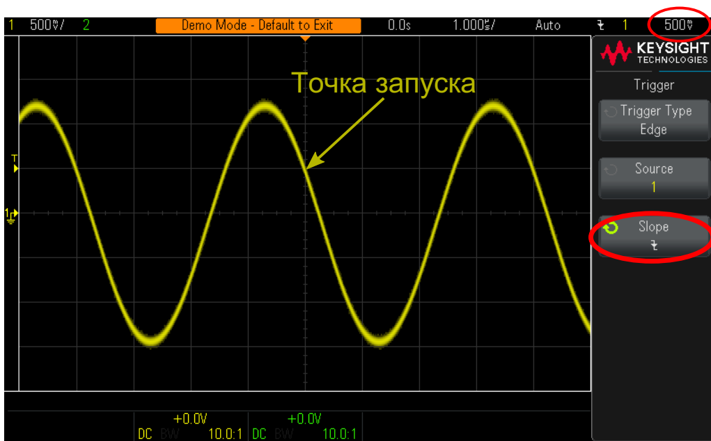
Рис. 13 Запуск по заднему фронту синусоидальной волны при +500 мВ
