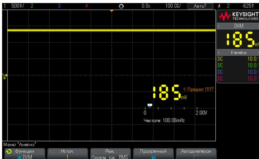
Цифровой вольтметр выполняет точные измерения RMS при частоте сигнала от 20 Гц до 100 кГц. Если частота сигнала выходит за пределы этого диапазона, на экране цифрового вольтметра появляется сообщение "<Предел ПП?" или ">Предел ПП?" для предупреждения о получении неточных результатов измерений RMS.
