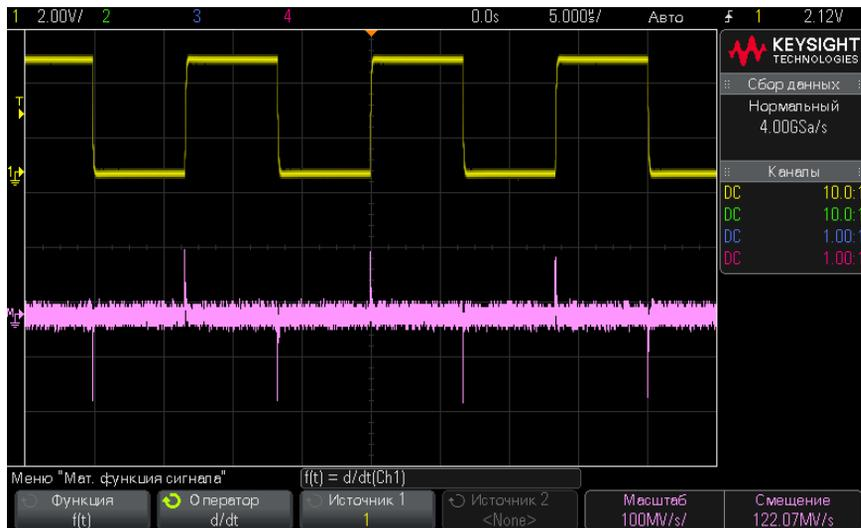
Рис. 7 Пример функции дифференцирования
