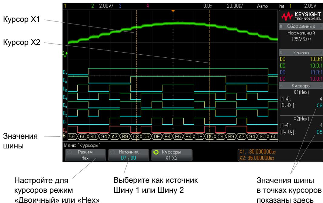
При нажатии кнопки **[Digital] (Цифров.)** с целью отобразить меню "Цифровой канал", на месте значений курсоров отображается цифровой индикатор активности, а в координатной сетке – значения шин в точках расположения курсоров.
