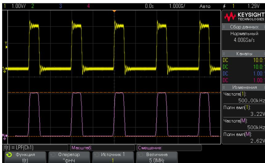
**Рис. 15** Пример фильтра низких частот
