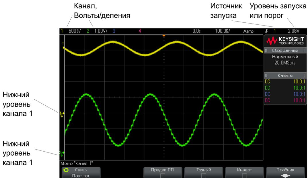
Уровень заземления сигнала для каждого отображаемого канала определяется по положению значка
