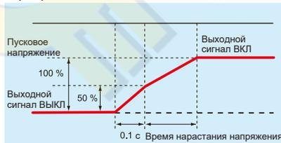
▲Пусковое напряжение может быть установлено на уровне 50% от испытательного напряжения.
