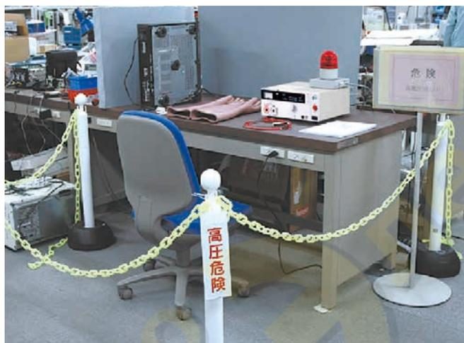
▲ На фотографии показан предупредительный знак «ОПАСНОСТЬ ВЫСОКОГО НАПРЯЖЕНИЯ» и цепь, ограждающая место испытания.
