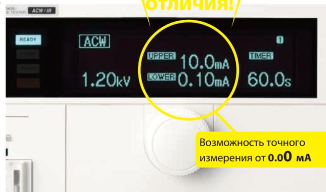
▲ Отображение настроек Hipot-испытания выдерживаемого напряжения переменного тока (пример)
