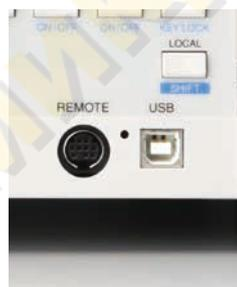
Разъем REMOTE и USB-порт на передней панели тестера используются исключительно для подключения дополнительных устройств.
