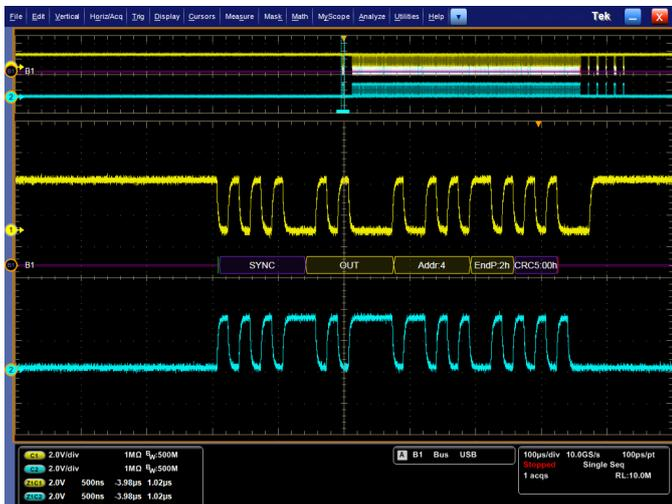
Запуск по пакету OUT Token полноскоростной последовательной шины USB. На осциллограмме сигнала шины отображается декодированное содержимое пакетов, в том числе Start (Пуск), Sync (Синхронизация), PID (Идентификатор пакета), Address (Адрес), End Point (Конечная точка), CRC (Контрольная сумма), Data values (Значения данных) и Stop (Стоп).
