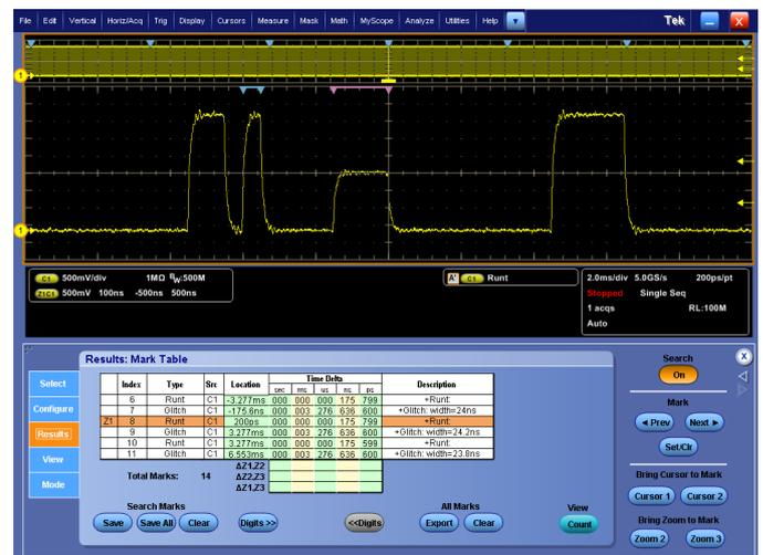
Поиск. Результаты расширенного поиска ранта или короткого глитча в длинной записи сигнала. Каждый момент появления ранта или глитча автоматически маркируется, чтобы потом его можно было быстро найти.
