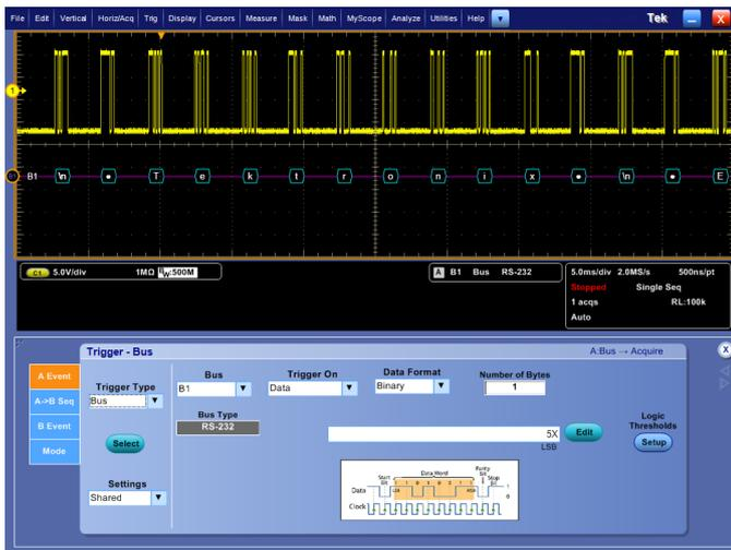
Захват – запуск по определенному пакету данных, передаваемому по шине RS-232. Полный набор функций запуска, включая запуск по содержимому пакета последовательных данных, позволяет быстро захватывать интересующее событие.
