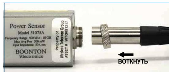
Рис. 10. Разъём для соединения датчика средней мощности с кабелем (разъединён).
