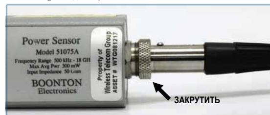
Рис. 11. Разъём для соединения датчика средней мощности с кабелем (соединён).
