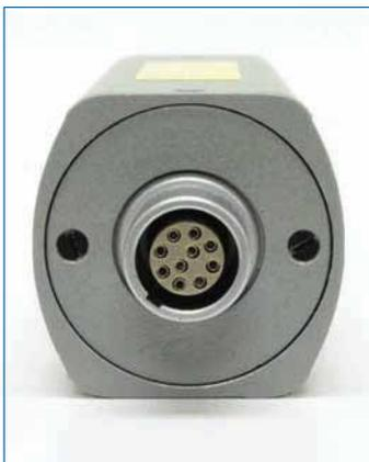
Рис. 3. Датчик измерителя пиковой мощности с 10-контактной розеткой для передачи информации о мощности измеряемого сигнала и обмена данными с базовым блоком измерителя мощности
