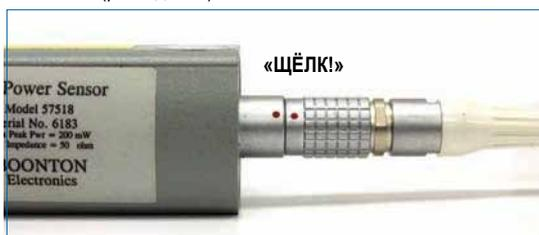
Рис. 8. Разъём для соединения датчика пиковой мощности с кабелем (соединён).
