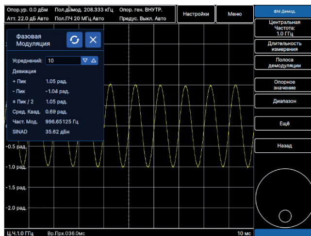
Рис. 41. Основное меню измерения ЧМ сигналов
