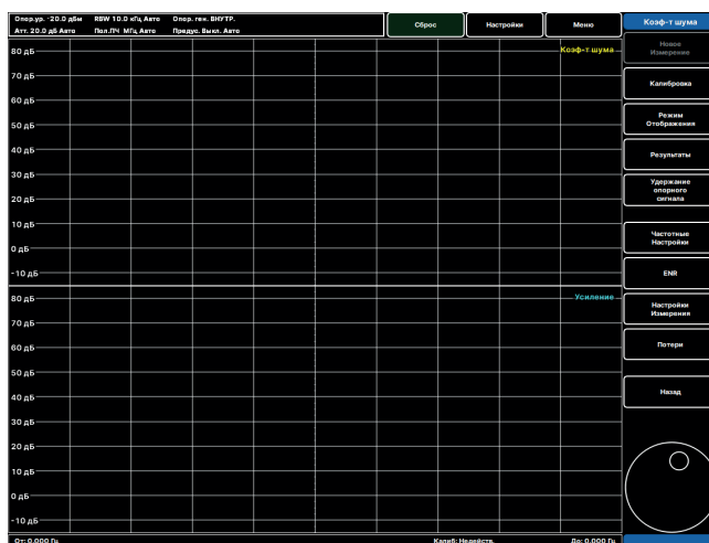
Рис. 50. Меню режима измерения коэффициента шума
