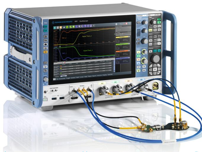
Анализ характеристик передачи дифференциального сигнального тракта во временной области на основе сравнения времени нарастания и формы импульса на эталонных выходах и выходах сигнального тракта
