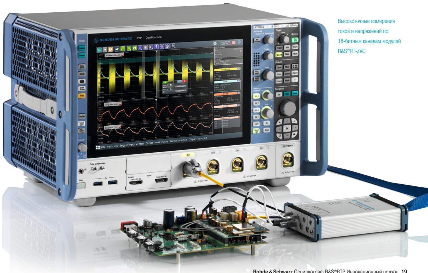
Высокоточные измерения токов и напряжений по 18-битным каналам модулей R&S®RT-ZVC
