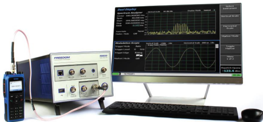
Испытательный радио-коммутатор R8600 разработан с учетом требований, предъявляемых производственной радиочастотной обстановкой. R8600 был специально разработан для обеспечения экономически эффективного решения для круглосуточного использования в производственных целях и способен выдерживать 150 Вт непрерывной РЧ мощности. После настройки требуется минимальное вмешательство оператора, помимо создания необходимых физических радиочастотных соединений.
