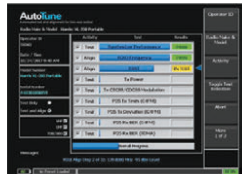
Экран состояния функции AutoTune радиостанции Harris XL-200P
