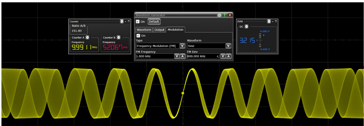
Генерация синусоидального сигнала 10 МГц с частотной модуляцией с одновременным измерением частоты двумя частотомерами и постоянного смещения цифровым вольтметром. Обратите внимание, что для работы частотомера и цифрового вольтметра включать каналы не требуется.
