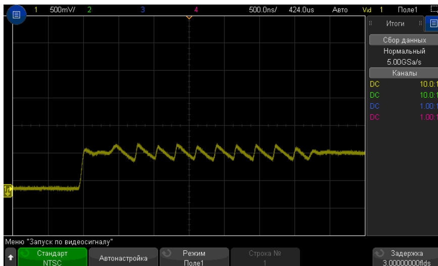
Рис. 33 Применение задержки поля для синхронизации по цветному полю 1 или 3 (режим "Поле 1")
