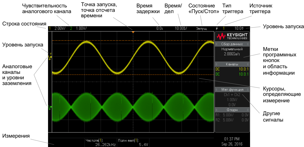
Рис. 1 Интерпретация показаний на экране осциллографа
