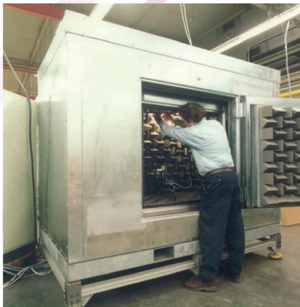
Пример безэховых мини-камер Microdyne® во время использования
