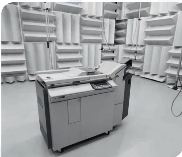
Полубезэховые камеры для испытания принтеров и другого офисного оборудования
