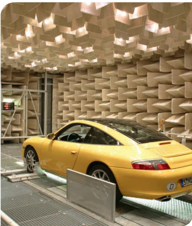
Полностью безэховые камеры с динамометром 4x2 для компании Porsche, Вейсах, Германия
