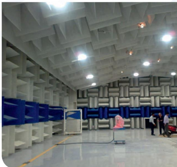
Полубезэховые камеры измерения внешнего шума для Bajaj Motorcycles из Индии
