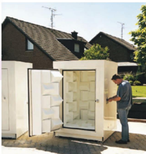
Пример безэховых мини-камер Microdyne® во время использования
