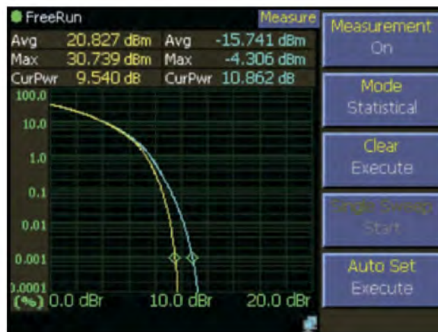
Рис. 3.2.2. Снимок экрана двойной комплементарной интегральной функции распределения (CCDF) измерителя 4540
