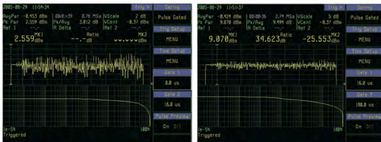
Рис. 7.2.5. Временная селекция полезной нагрузки сигнала улучшает точность статических измерений пиковой мощности за счет исключения интервала «сигнал выключен» между кадрами благодаря использованию синхронного запуска и курсоров временной селекции. На левом экране показана функция CCDF для вступительной части, которая имеет низкое отношение пикового к среднему уровню мощности (3 дБ), и имеет относительно плоскую функцию CCDF. На правом экране показана функция CCDF только для полезной нагрузки, которая имеет намного более высокое отношение пикового к среднему уровню мощности (9,5 дБ), что приводит к намного большему напряжению в цепи прохождения сигнала.
