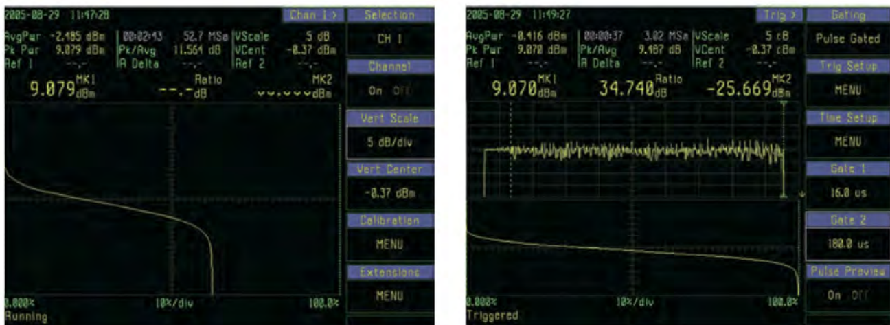
Рис. 6.2.3. Снимки экрана, показывающие измерения с использованием курсоров и статистическое распределение
