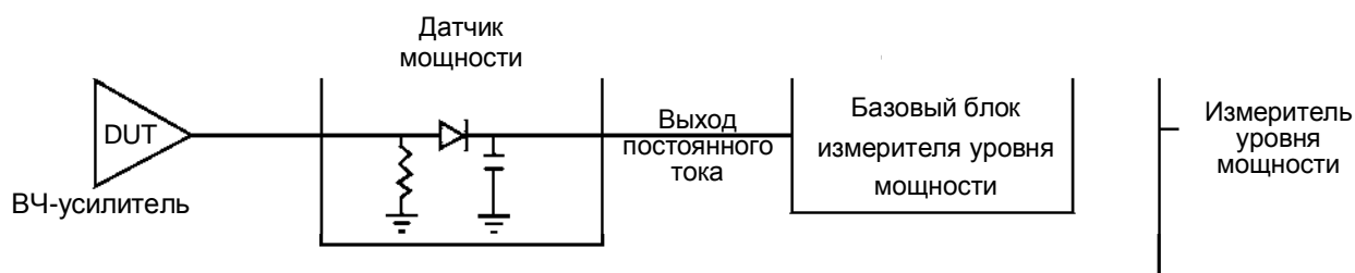
ИЗМЕРЕНИЕ УРОВНЯ МОЩНОСТИ НА СОГЛАСОВАННОЙ НАГРУЗКЕ
