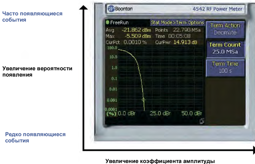
Рис. 8.3.5 Функция CCDF модулированного сигнала системы связи
