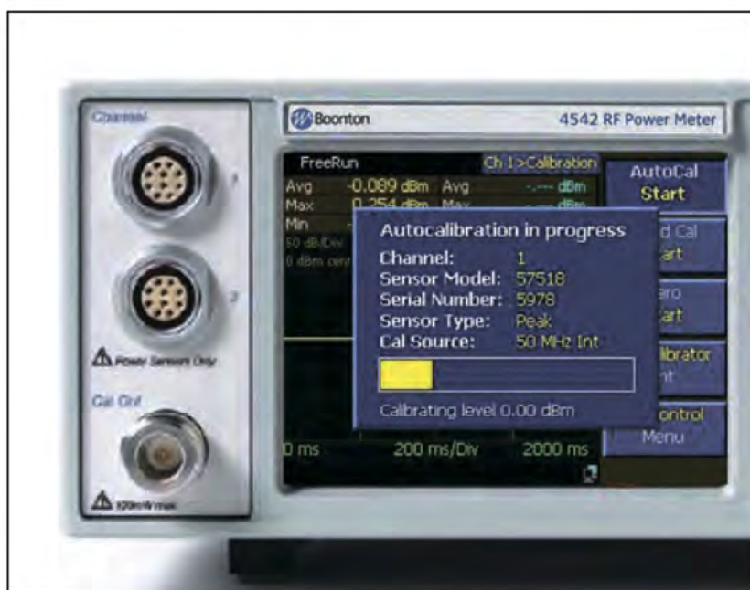
Выполнение автоматической калибровки датчика
