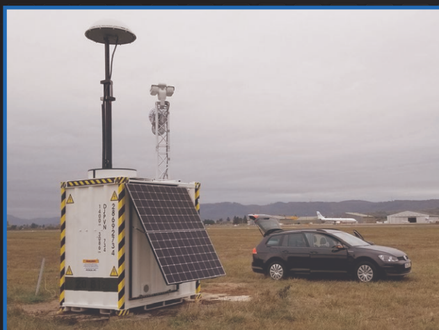
Установка в аэропорту с помощью контейнера для системы AARTOS DDS
