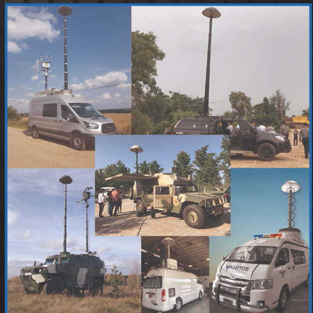
Примеры размещения системы AARTOS DDS на транспортном средстве с выдвигной мачтой
