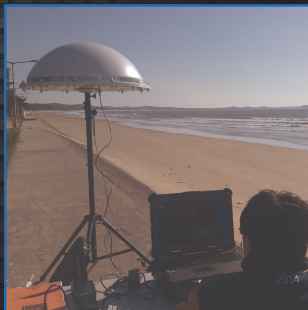
Дальность системы AARTOS DDS и полевые испытания на береговой полосе
