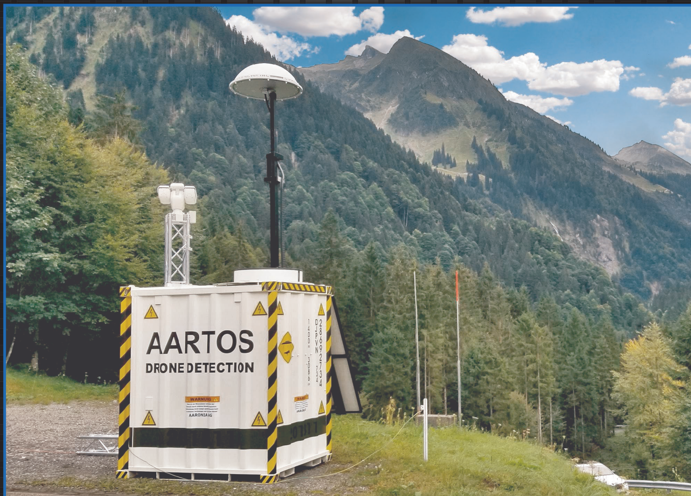
Контейнер системы AARTOS DDS развернут в швейцарских Альпах, работает автономно в течение 3 месяцев
