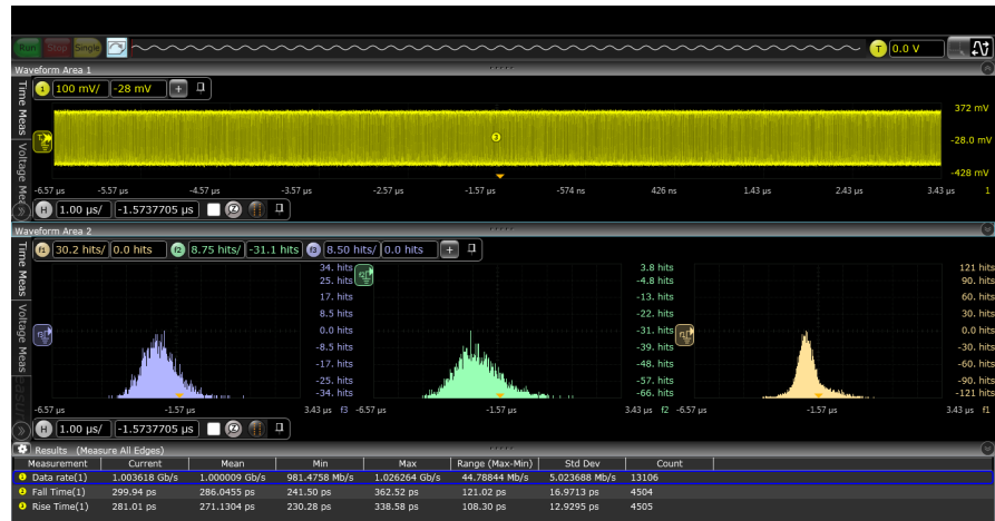
Благодаря равномерной частотной характеристике и низкому уровню шумов осциллографы серии Z способны точно измерять составляющие джиттера, такие как межсимвольная интерференция (ISI).
